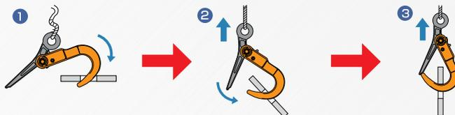
① シャックルを開放状態にし、敷鉄板の穴にフック先端を差し込みます。
